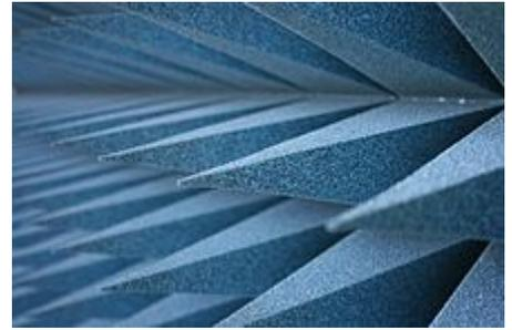
Schaumstoffpyramiden zur Absorption von elektromagnetischen Wellen bei funktechnischer Anwendung
