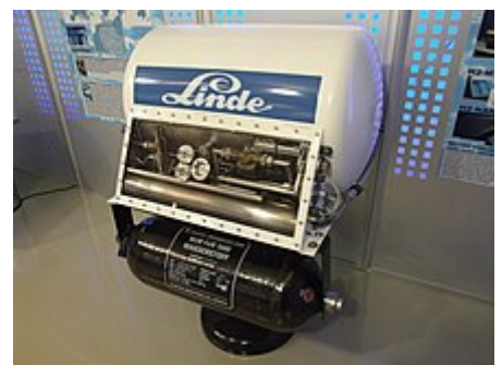
Tank für flüssigen Wasserstoff im Museum Autovision in Altlußheim
